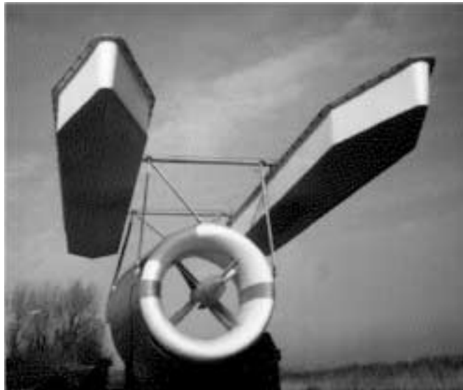
Figuur 16 Tocardo Turbine (Aqua75). De behuizing in de vorm van een venturi hangt onder een ponton. De generator is ingebouwd zoals een Bulb generator in lijn met de as van de rotor en geheel onder water.
